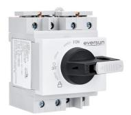
Der DC-Trennschalter der Serie GDL1 wird in Photovoltaikanlagen mit einer Leistung von 1-20 kW für den privaten oder gewerblichen Gebrauch eingesetzt und zwischen den Photovoltaikmodulen und den Wechselrichtern platziert. Die Überbrückungszeit beträgt weniger als 8 ms, die maximale Spannung beträgt bis zu 1200V DC.
