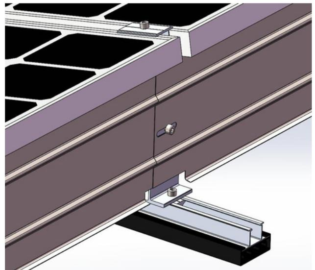
Bei zwei oder mehreren Flachdach Halterungen nebeneinander kann das Windschutzblech übereinander gelegt werden und mit 1 oder bei starkem Wind, mit zwei Schrauben befestigt werden. Falls es kein vorhandenes Loch gibt, oder die Lochgröße nicht passt, können Sie ein eigenes Loch bohren.
