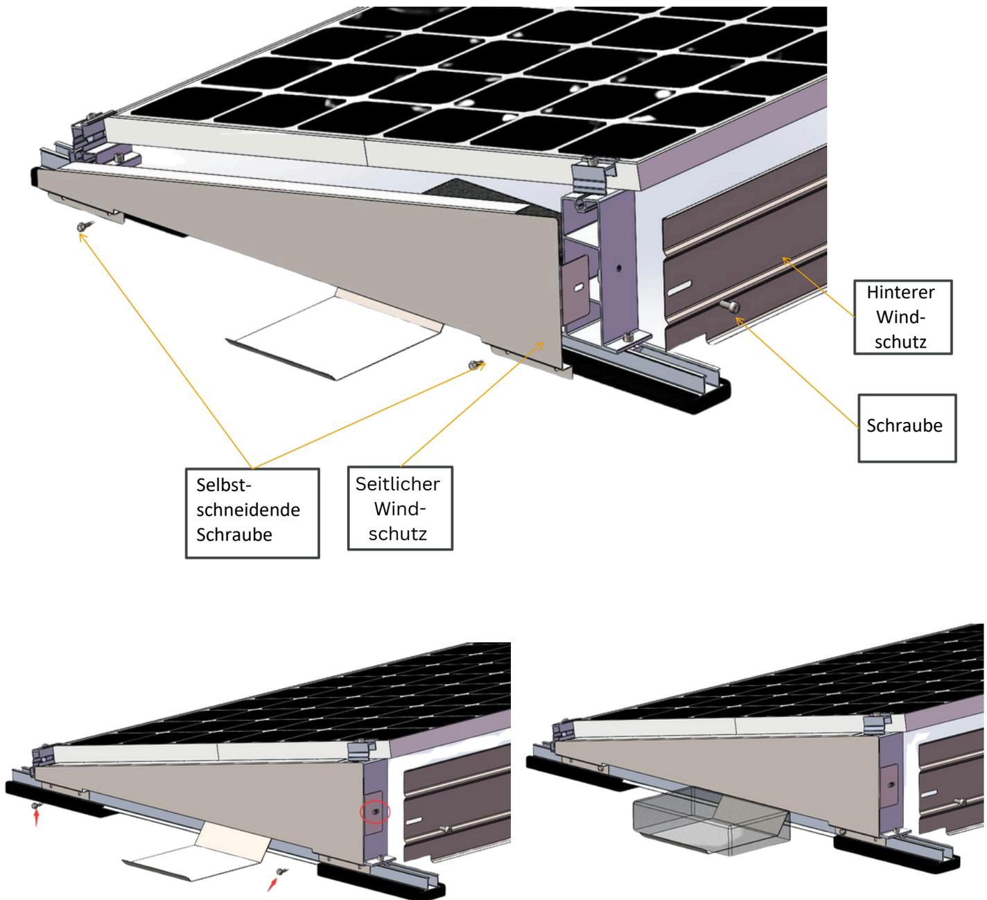
**Montage des seitlichen Windschutzblechs:** Bevor Sie die Windschutzscheibe einbauen, müssen Sie die Balastplatte und den das innenliegende Gewicht einbauen. Sobald der hintere und seitliche Windschutz eingebaut ist, wird es deutlich schwieriger das Gewicht an in die Innenseite zu bekommen.
