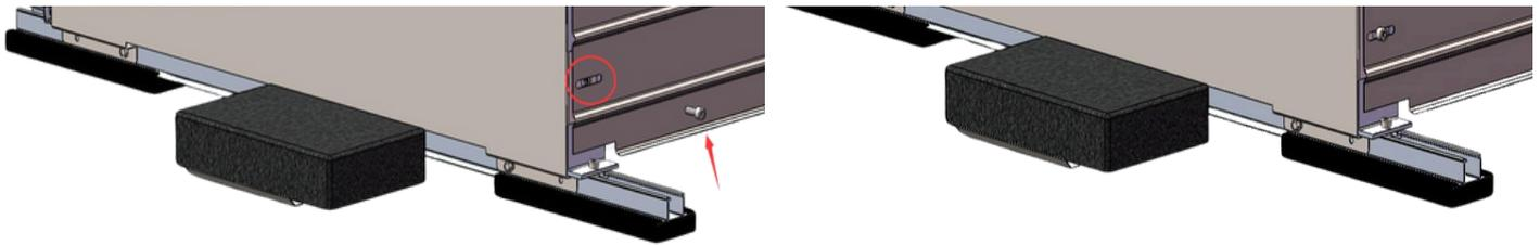
**Montage des hinteren Windschutzblechs:** Verwenden Sie ebenfalls selbstschneidende Schrauben, um das hintere Windschutzblech zu befestigen. Wenn kein Loch vorhanden ist, oder die Lochgröße falsch ist, können Sie selbst ein neues Loch bohren und selbstbohrende Schrauben zur Befestigung verwenden.
